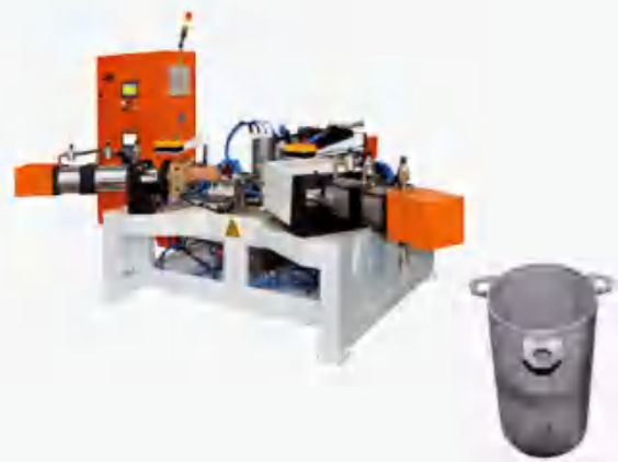
220KVA 三头支脚中频凸焊机 220KVA MFDC Welder For Base Legs
