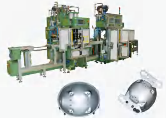
下壳体机脚与销钉自动焊机 Automatic Welder For Base Legs & Pins
